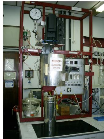
Figura 1 - Forno de pirólise utilizada nos testes de co-pirólise de polipropileno e gasóleo.
