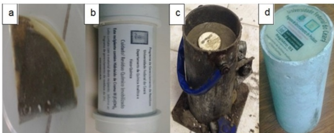
Figura 4. (a) precipitado pronto para ser imobilizado, (b) cápsula de PVC, (c) encerramento da cápsula de PVC no corpo de prova, (d) produto final.
