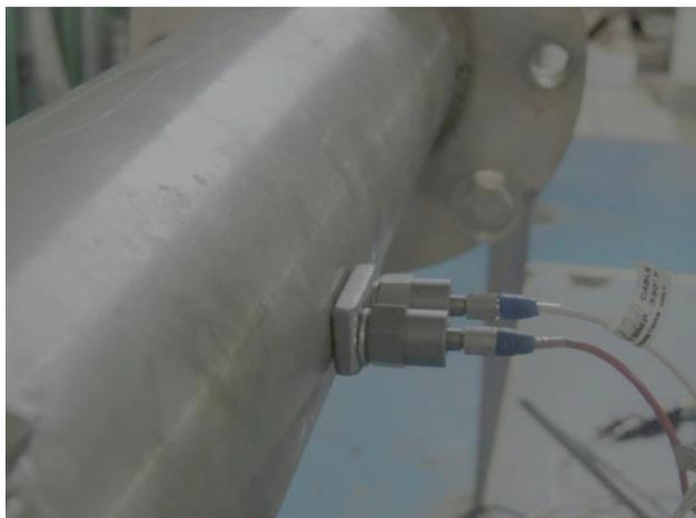
**Figura 1.** Acelerômetros instalados. Ligou-se a bomba de injeção de água e
