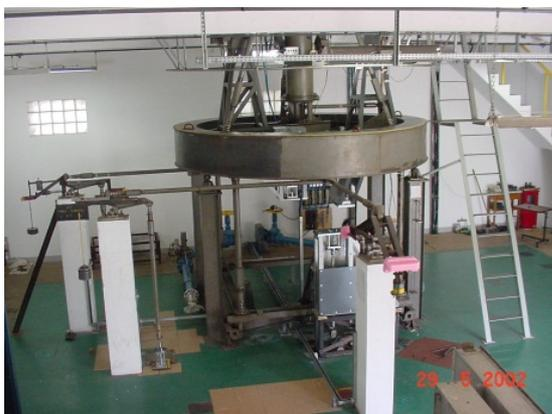
**Figura 2.** A Balança Dinamométrica de Esforços Aerodinâmicos. O mastro superior adentra na seção de ensaio (Figura 1). Gentileza do Instituto de Aeronáutica e Espaço - IAE
