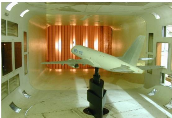
**Figura 1.** Seção de ensaio do Túnel de Vento Gentileza do Instituto de Aeronáutica e Espaço – IAE
