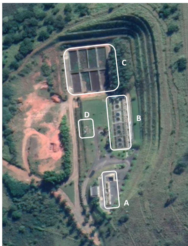
Figura 3. Vista aérea da ETE Sapucaí (Itajubá-MG): A – Gradeamento + Desarenador; B – Reatores Anaeróbios em Paralelo (4); C – Leitos de Secagem do Lodo; D – Queimador do Biogás. Fonte: Google Earth.
