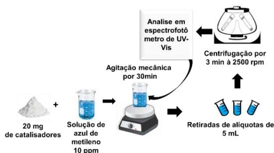
Figura 2. Esquema representativo dos testes adsorptivos com o corante azul de metileno. Fonte: Autoria própria.
