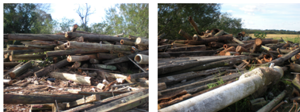
Figura 2. Postes tratados com CCA após serem retirados de serviço. Fonte: Ferrarini, 2012.
