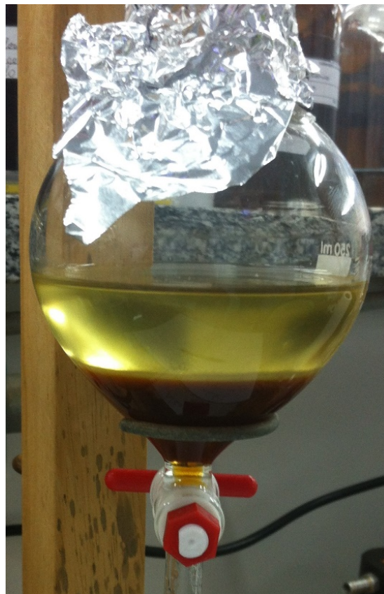
Figura 1: Separação de fases após transesterificação do sebo.
