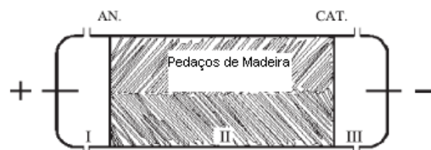
Figura 4. Princípio da remediação eletrolítica. AN= membrana de troca aniônica. CAT = membrana de troca catiônica. Adaptação: Pedersen, 2005.
