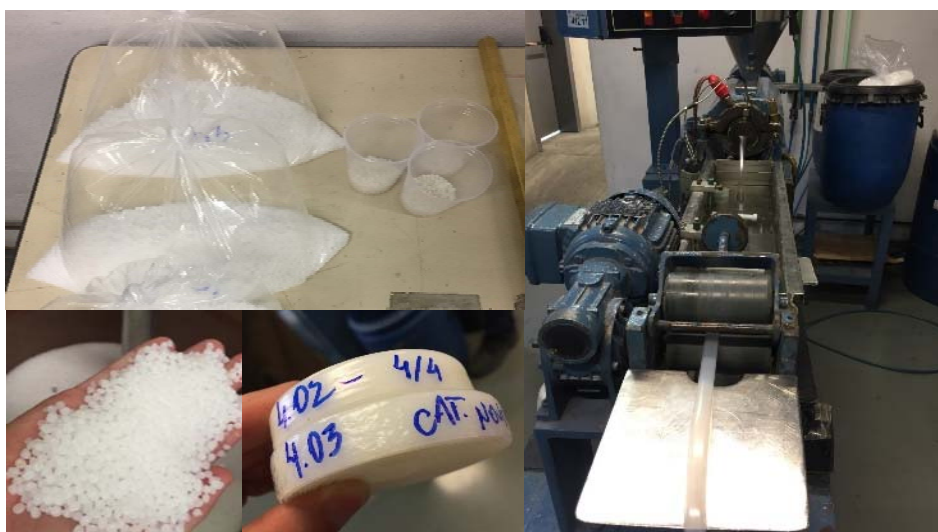
Figura 1: Preparação de mistura para produção de fitas em extrusora de bancada.
