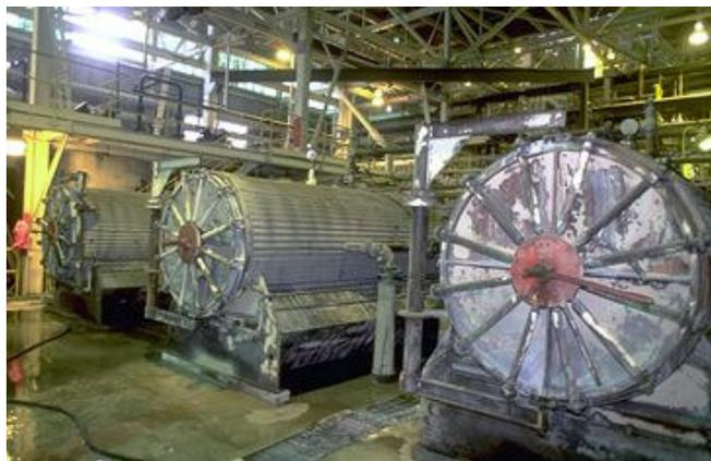
Uma pequena quantidade de agente flocculante é adicionada à solução e a mistura é enviada a um clarificador onde a parte insolúvel decanta no fundo do tanque. A solução de soda barrilha clarificada é tratada com carvão ativado para absorver qualquer partícula orgânica que estiver dissolvida na solução. Um filtro auxiliar de terra diatomácea é adicionado e o carvão é removido.
