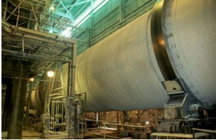
O produto do refinamento é aquecido em fornos, que são alimentados com gás natural. Este aquecimento converte o bicarbonato de sódio para carbonato de sódio anidro, liberando  $\text{CO}_2$  e  $\text{H}_2\text{O}$ , segundo a equação:  $2(\text{Na}_2\text{CO}_3 \cdot \text{NaHCO}_3 \cdot 2\text{H}_2\text{O}) \rightarrow 3\text{Na}_2\text{CO}_3 + \text{CO}_2 + 5\text{H}_2\text{O}$ .
