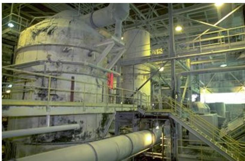
A água é evaporada da solução formando cristais de carbonato de sódio monohidratado. A evaporação ocorre em evaporadores de circulação forçada aquecidos com vapor.
