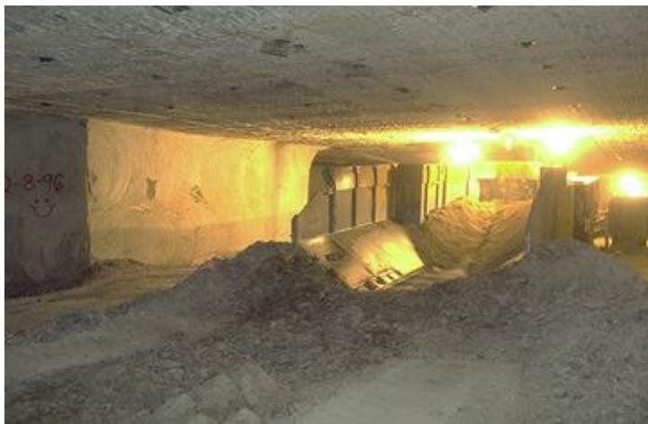
As rochas são trituradas em pedaços com diâmetro inferior à 15 centímetros e alocados em depósitos subterrâneos. Neste estágio, as rochas estão de 87 a 90% puras.
