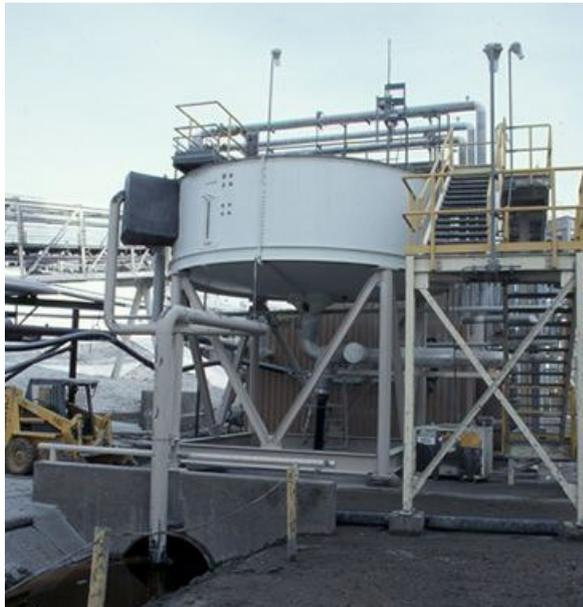
O produto calcinado é misturado com uma solução diluída de soda barrilha e água para formar uma solução saturada.  $3\text{Na}_2\text{CO}_3 + \text{CO}_2 + 5\text{H}_2\text{O} \rightarrow 2\text{Na} + \text{CO}_3 + \text{H}_2\text{O}$ . Classificadores de taxa separam toda a soda não-dissolvida (insolúvel).
