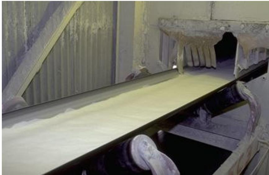
O produto que sai do forno é filtrado para remover qualquer material acima do tamanho desejado e enviado para classificadores mais arejados onde a soda é resfriada em temperatura ambiente. Ciclones removem as partículas indesejadas, resultando no produto final, ou seja, carbonato de sódio puro, branco e fino.
