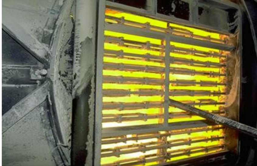
Os cristais são secos em fornos aquecidos com gás natural produzindo carbonato de sódio anidro livre de umidade.  $\text{Na}_2\text{CO}_3 \cdot \text{H}_2\text{O}$  (monohidratado)  $\rightarrow$   $\text{Na}_2\text{CO}_3$  (Anidro).
